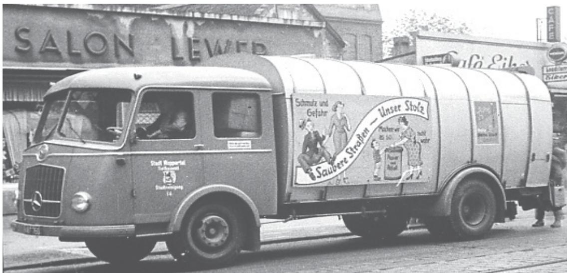
Mercedes Fahrgestell (Großraumkabine) mit KUKA Drehtrommel nach 1956 auf der Friedrich-Engels-Allee.
